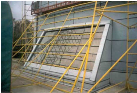
Resim 1. Giydirme cephe sistemlerinde su geçirimsizlik deneyi uygulaması
