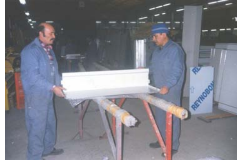
Resim 2. Alüminyum kompozit panellerin şekillendirilmesi
