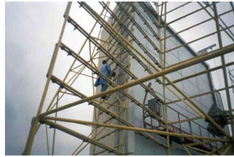
Resim 1. Giydirme cephe sistemlerinde su geçirimsizlik deneyi uygulaması
